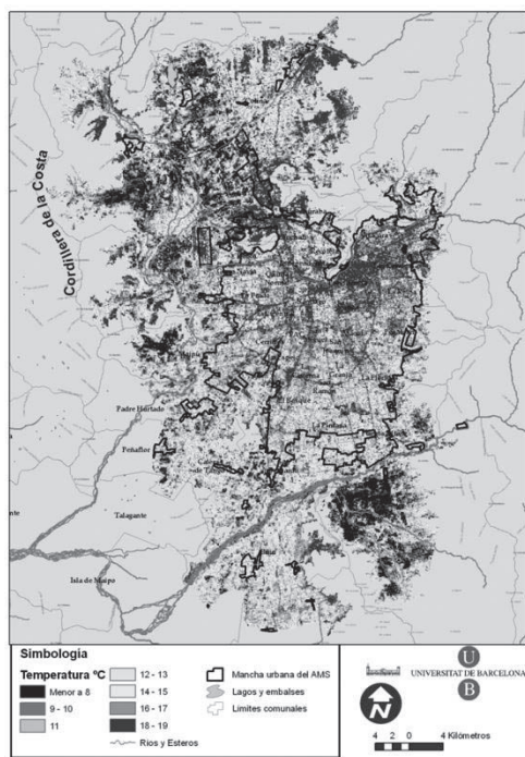
Figura N° 11 Temperatura de emisión superficial a las 0:00 a. m. del día 28/04/2006, usando sensor Terra ASTER.
